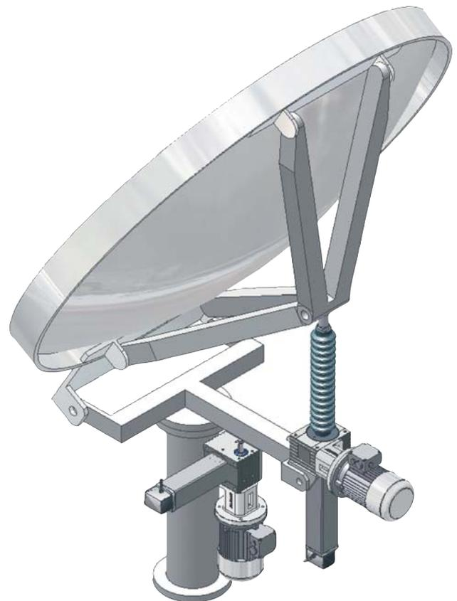
Parabolantenne  $D = 3,3$  m, beide Achsen – Azimuth + Elevation – je 50 kN, Verstellweg pro Bewegung 0,02 - 0,05 mm; die Anlagen sind im Freien an einer Meeresküste installiert.
